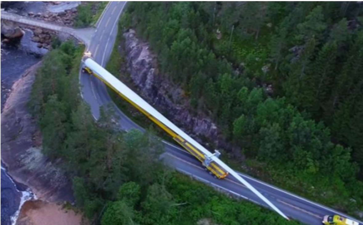
Figur 4.3: Transport av 70 meter lange turbinblader til Tonstad vindpark. Foto: Tonstad vindpark AS
